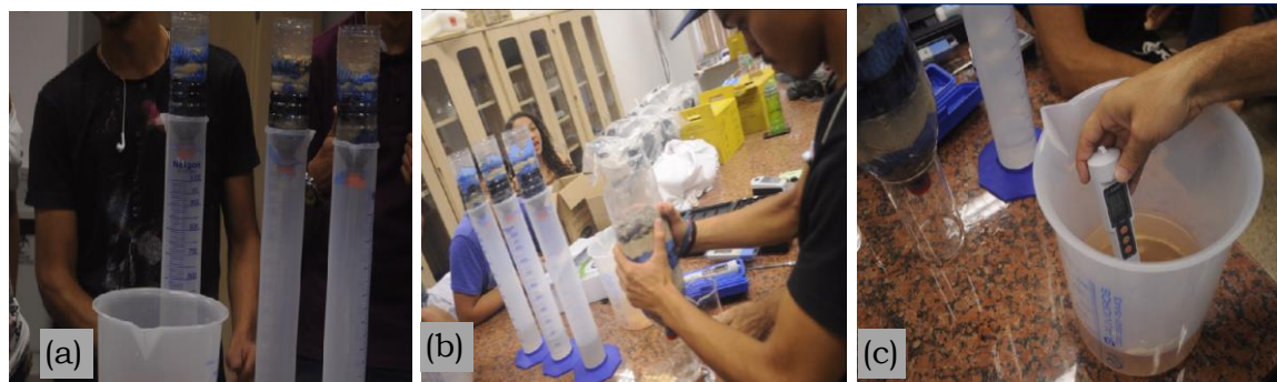
Figuras 2 – (a) e (b) Demonstração do processo de filtração; (c) Determinação do pH da amostra de água bruta antes do processo de filtração.
